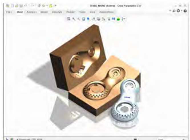
Fotorealistische PTC Creo Darstellung von Kernform und Kunststoffteilen
